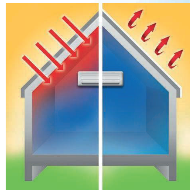
Pénétration et réflexion des ondes de chaleur sans et avec revêtement thermo-réfléchissant KOFATERM TOITURE
